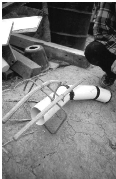
Lock-on konstrukcja przygotowana do zatopienia w betonie.
